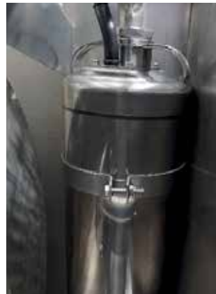
Hochdruckpumpe für Trommelabreinigung, nicht trocken laufen lassen, mit Flutklappe die Pumpenkammer fluten
