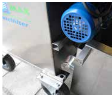
Teichmax 2 wird mit den zwei Arretierstiften an den Teichmax 1 angekoppelt
