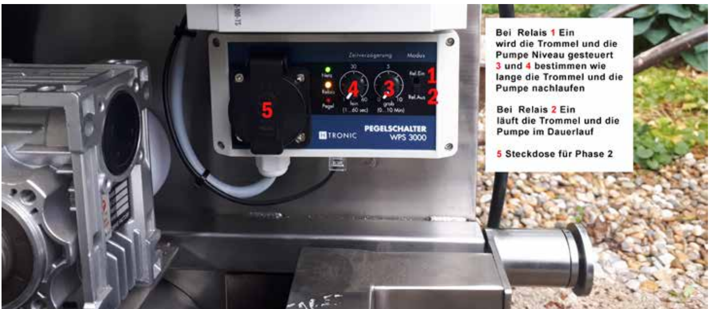
Zentrale Schaltereinheit für beide Geräte, das Gerät muss mit min. 16 A abgesichert werden
