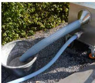
Schmutzwasserauslauf und Verbindungsschlauch zwischen Schlamm-sauger und TEICHMAX.
