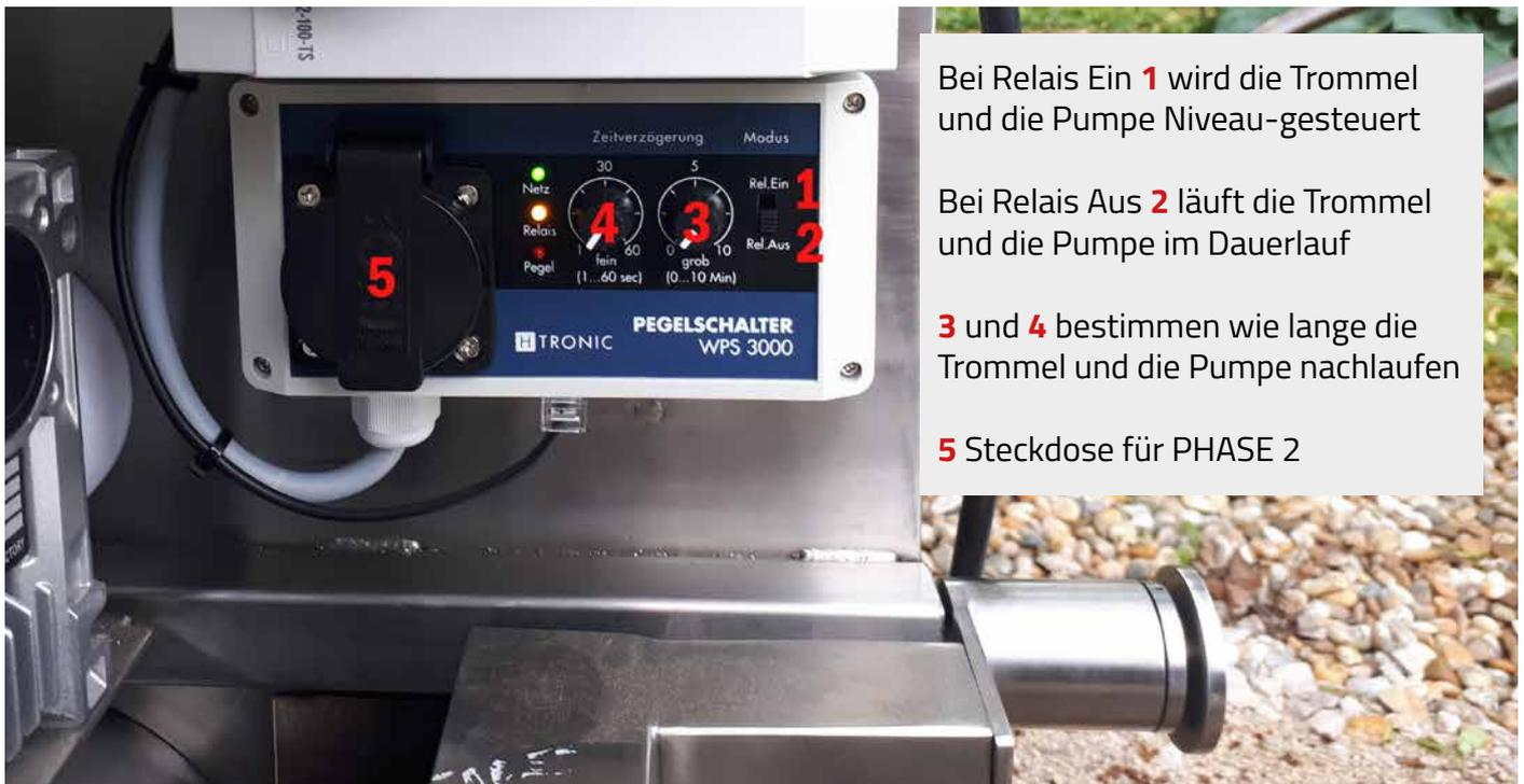
Bei Relais Ein **1** wird die Trommel und die Pumpe Niveau-gesteuert
