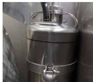
Hochdruckpumpe für Trommelabreinigung. Nicht trocken laufen lassen, mit Flutklappe die Pumpenkammer fluten.
