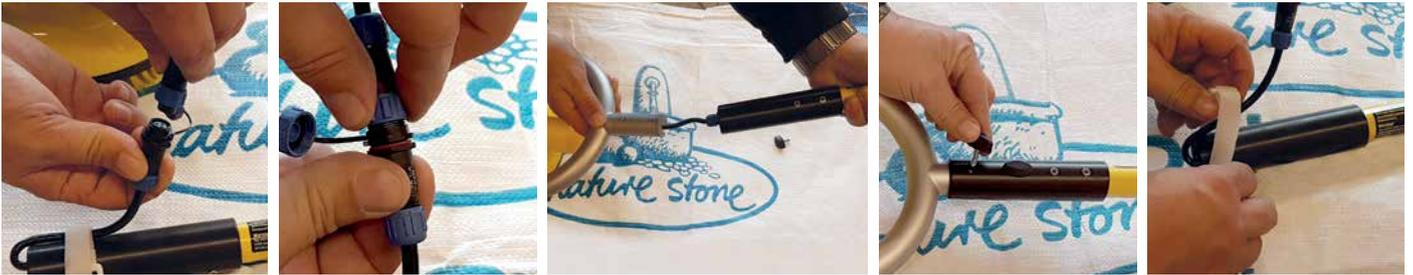
**Achtung!** Wird das Kabelhalteband vor dem Verbinden der Stecker gelöst, kann das Kabel in die Teleskopstange zurück rutschen. Nach dem Verbinden der Kabel den Adapter der BISAM 22 BÜRSTE samt dem Kabel in die Teleskopstange einschieben und mit den Flügelschrauben fixieren. Klettband aufbewahren und bei einer eventuellen Demontage das Kabel wie gehabt wieder an der Stange fixieren.
