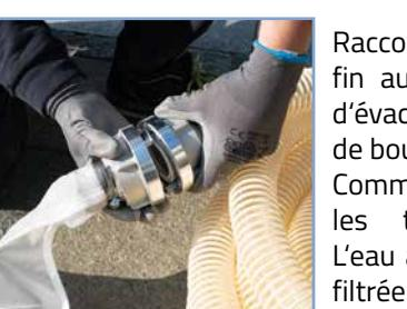
Raccordez le sac filtrant fin au raccord C du tuyau d'évacuation de l'aspirateur de boues d'étang. Commencez maintenant les travaux d'aspiration. L'eau aspirée est lentement filtrée. Veillez à ne pas trop remplir le sac filtrant fin, car il pourrait éclater.
