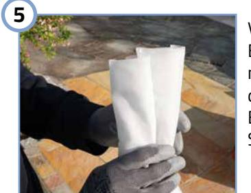
Verschließen Sie das offene Ende des Feinfiltersacks nach der Reinigung wieder mit dem Kabelbinder. Befolgen Sie dazu die Schritte 6 bis 9.
