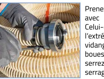
Prenez le raccord C fourni avec le sac filtrant fine. Celui-ci est raccordé à l'extrémité du tuyau de vidange de l'aspirateur de boues d'étang. Pour ce faire, serrez bien le collier de serrage.
