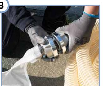
Schließen Sie den Feinfiltersack an die C-Kupplung des Ablaufschlauchs des Teichschlammsaugers an. Beginnen Sie nun mit den Saugarbeiten. Das eingesaugte Wasser wird langsam gefiltert. Achten Sie darauf, den Feinfiltersack nicht zu überfüllen, da er sonst platzen könnte.
