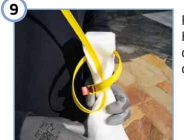
Führen Sie das Ende des Kabelbinders zur Sicherung durch die beim Falten gebildete Schlaufe.
