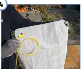
Eine Seite des Feinfiltersacks ist offen, wodurch er leichter zu reinigen ist. Durch den roten Hebel am Spezialkabelbinder kann dieser entriegelt und geöffnet werden. Reinigen Sie den Feinfiltersack gründlich.
