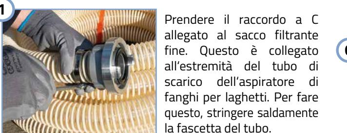
Prendere il raccordo a C allegato al sacco filtrante fine. Questo è collegato all'estremità del tubo di scarico dell'aspiratore di fango per laghetti. Per fare questo, stringere saldamente la fascetta del tubo.
