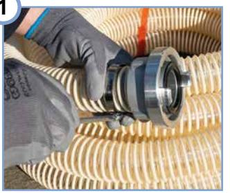
Nehmen Sie die dem Feinfiltersack beiliegende C-Kupplung. Diese wird am Ende des Ablaufschlauchs des Teichschlammsaugers angeschlossen. Ziehen Sie dazu die Schlauchschelle fest an.
