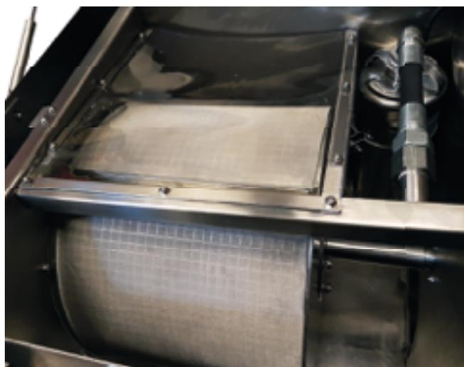
Filtertrommel mit 50 µm feinem Edelstahlsieb
