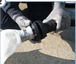
Schließen Sie den Feinfiltersack an die C-Kupplung des Ablaufschlauchs des Teichschlamsaugers an. Beginnen Sie nun mit den Saugarbeiten. Das eingesaugte Wasser wird langsam gefiltert. Achten Sie darauf den Feinfiltersack nicht zu überfüllen, da er sonst platzen könnte.
