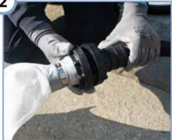
Conecte la bolsa filtrante fina al acoplamiento C de la manguera de drenaje del aspirador de lodos. Ahora empieza el trabajo de succión. El agua aspirada se filtra lentamente. Tenga cuidado de no llenar demasiado la bolsa filtrante fina, ya que podría reventar.
