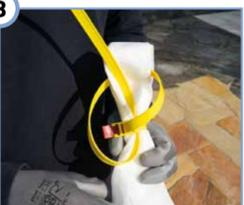
Führen Sie das Ende des Kabelbinders zur Sicherung durch die beim Falte gebildete Schlaufe.
