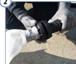
Raccordez le sac filtrant fin au raccord C du tuyau d'évacuation de l'aspirateur de boues de bassin. Commencez maintenant les travaux d'aspiration. L'eau aspirée est lentement filtrée. Veillez à ne pas trop remplir le sac filtrant fin, car il pourrait éclater.
