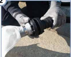
Collegare il sacco filtrante fine al raccordo C del tubo di scarico dell'aspiratore di fanghi del laghetto. Ora inizia il lavoro di aspirazione. L'acqua aspirata viene filtrata lentamente. Fate attenzione a non riempire troppo il sacco filtrante fine, perché potrebbe scoppiare.
