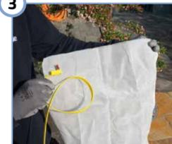
Un côté du sac filtrant fin est ouvert, ce qui le rend plus facile à nettoyer. Le levier rouge du serre-câble spécial permet de le déverrouiller et de l'ouvrir. Nettoyez soigneusement le sac filtrant fin.
