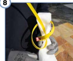
Passez l'extrémité du serre-câble dans la boucle formée lors du pliage pour le sécuriser.
