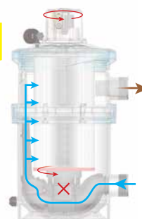
Wasserfluss bei Rückspülvorgang
